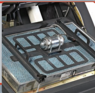
O patenteado filtro vibratório Multispectrum™ previne o acúmulo de poeira que poderia impedir o desempenho do equipamento.
