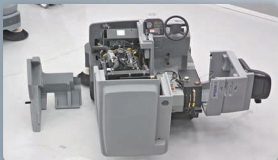
O excepcional sistema sem ferramentas NoTools™ facilita a manutenção do equipamento Nilfisk. O acesso às partes hidráulicas e ao motor do equipamento, de maneira facilitada, economiza tempo e mantém baixo o custo do serviço.
