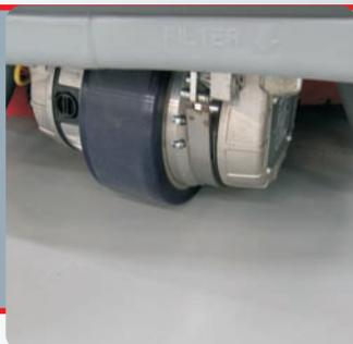
Rodas dianteiras e traseiras de poliuretano: tração excepcional, em pisos secos ou molhados, sem marcar e resistente ao desgaste.
